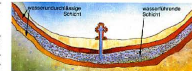
Abb. 19.2: Schema eines artesischen Brunnens
