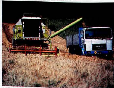
Abb. 58.5: Der Mähdrescher schneidet und drischt in einem Arbeitsgang
