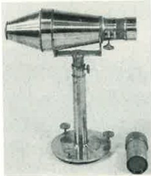
Voigtländerkamera mit (in Wien gebautem) Petzval-Objektiv (1840)
